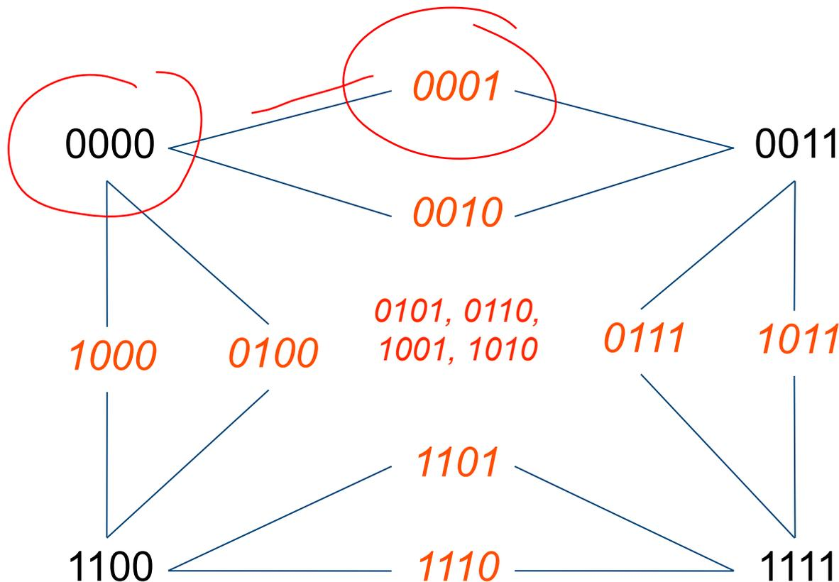
Kanten verbinden Frames, die sich nur in einem Bit unterscheiden
